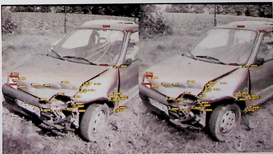
Ryc. 4. Zorientowana para zdjęć wraz z wykonaną stereodigitalizacją uszkodzeń pojazdu Fig. 4. Aligned photos with stereodigitalisation of vehicle damages
