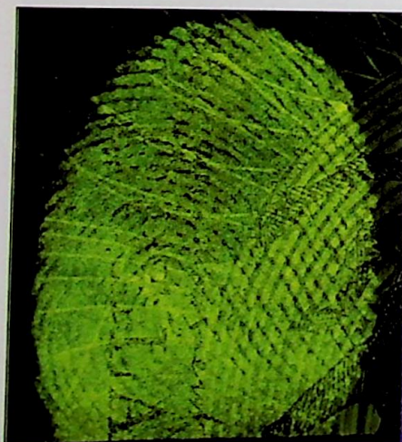
Ryc. 10. Ślad trzydniowy na banknocie australijskim o nominale 10 dolarów ujawniony proszkiem BVDA B-47950 po cyjanoakrylaniu (350 nm – filtr 530 nm)
