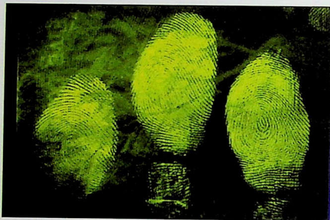
Ryc. 8. Ślady jednodniowe na banknocie australijskim o nominale 5 dolarów ujawnione proszkiem BVDA B-47950 (350 nm – filtr 530 nm)
