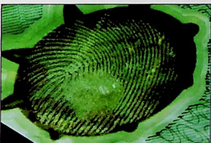
Ryc. 17. Ślad trzydniowy ujawniony Ardrexem po cyanoakrylanie w „przeźroczystym oknie” banknotu rumuńskiego (350 nm – filtr 475 nm) Fig. 17. Three-day-old mark developed with Ardrex after cyanoacrylate fuming in „transparent window” of Romanian banknote (350 nm, 475 nm filter)
