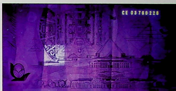
Ryc. 5. Banknot australijski o nominale 5 dolarów w świetle 350 nm – filtr ogledzinowy 385 nm
