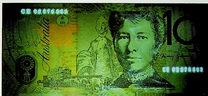
Ryc. 4. Banknot australijski o nominale 10 dolarów w świetle 350 nm – filtr ogledzinowy 475 nm
