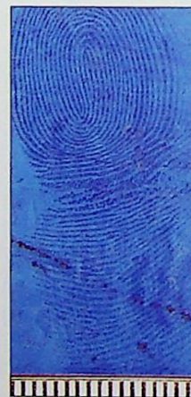
Ryc. 12. Ślad linii papilarnych ujawniony na taśmie niebieskiej odklejonej od kartonu Fig. 12. Fingerprint developed on blue tape separated from cardboard
