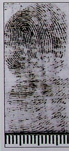
Ryc. 21. Ślad linii papilarnych ujawniony na taśmie czarnej Duck odklejonej od białej kartki Fig. 21. Fingermark developed on black Duck tape separated from white paper
