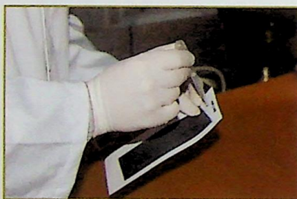
Ryc. 10. Odklejanie taśmy od podłoża papierowego – nakrapianie Fig. 10. Separation of tapes from paper background – application of drops
