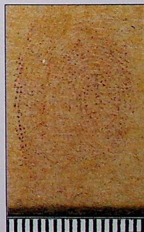
Ryc. 35. Ślad linii papilarnych ujawniony na szarym kartonie po odklejeniu taśmy szarej pakowej Fig. 35. Fingerprint developed on gray cardboard after separation of gray packing tape
