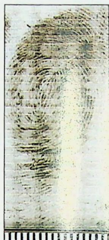
Ryc. 14. Ślad linii papilarnych ujawniony na taśmie czarnej Duck odklejonej od kartonu Fig. 14. Fingermark developed on black Duck tape separated from cardboard
