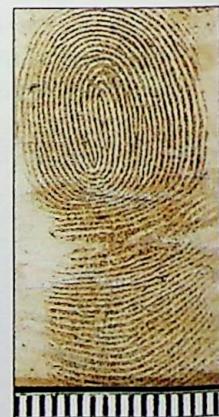
Ryc. 13. Ślad linii papilarnych ujawniony na taśmie papierowej malarskiej odklejonej od kartonu Fig. 13. Fingerprint developed on paper tape separated from cardboard
