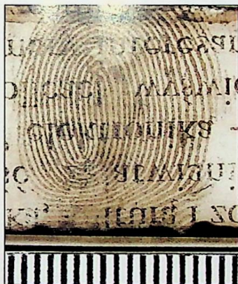
Ryc. 31. Ślad linii papilarnych ujawniony na taśmie Magic Tape odklejonej od gazety Fig. 31. Fingerprint developed on Magic Tape separated from newspaper
