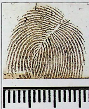
Ryc. 17. Ślad linii papilarnych ujawniony na taśmie Magic Tape odklejonej od kartonu Fig. 17. Fingermark developed on Magic Tape separated from cardboard
