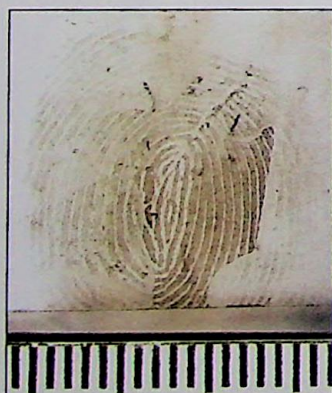
Ryc. 24. Ślad linii papilarnych ujawniony na taśmie przezroczystej wąskiej odklejonej od białej kartki Fig. 24. Fingerprint developed on transparent narrow tape separated from white paper
