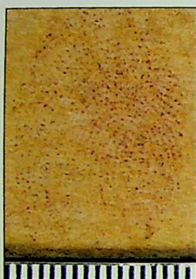
Ryc. 36. Ślad linii papilarnych ujawniony na szarym kartonie po odklejeniu taśmy przezroczystej wąskiej
