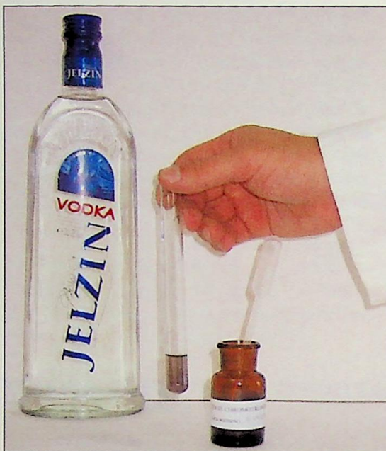
Ryc. 6. Wykonanie testu na formaldehyd z kwasem chromotropowym Fig. 6. Performance of formaldehyde test with chromotropic acid
