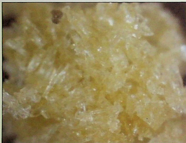
Ryc. 4. Skupienia słomkowożółtych kryształów z gleby z odpadami po nielegalnym tajnym laboratorium, fotografia z mikroskopu stereoskopowego OLYMPUS SZX 12, powiększenie ok. 55 x Fig. 4. Clusters of straw-coloured crystals from soil with waste-products from clandestine laboratory – stereomicroscope photograph (OLYMPUS SZX 12), magn. 55x
