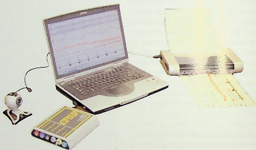
Ryc. 1. Ośmiokanałowy poligraf cyfrowy CPS II firmy Stoelting, mający w standardowym wyposażeniu kanał do analizy parametrów pobudzenia psychofizjologicznego głosu
