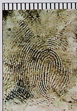
Ryc. 14. Ślad linii papilarnych ujawniony na taśmie papierowej malarskiej Fig. 14. Latent fingerprint developed on paper tape
