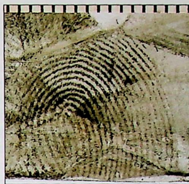
Ryc. 10. Ślad linii papilarnych ujawniony na taśmie Magic Tape Fig. 10. Latent fingerprint developed on Magic Tape
