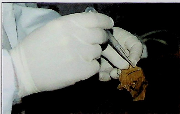
Ryc. 3. Rozdzielanie posklejanej taśmy – nakrapianie Fig. 3. Tape separation – application of drops
