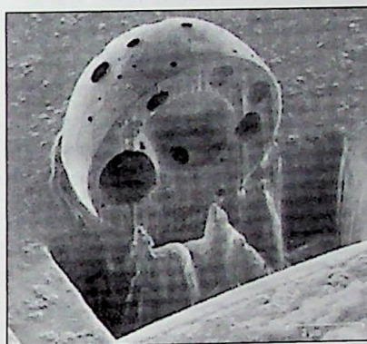
Ryc. 1. Przekrój cząstki osmalin (z amunicji DN AG, GECCO, kal. 9 mm)
