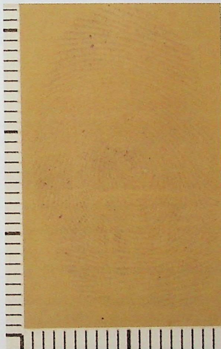
Ryc. 2. Ślad linii papilarnych ujawniony na taśmie pakowej roztworem fioletu krystalicznego Fig. 2. Latent developed with crystal violet on opaque adhesive tape
