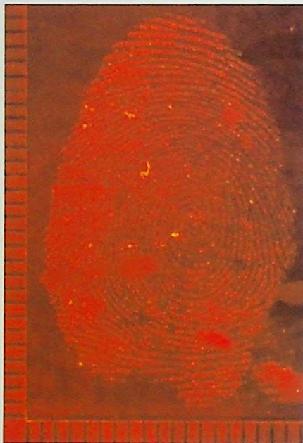
Ryc. 5. Ślad linii papilarnych ujawniony na taśmie pakowej roztworem Tape-Glo Fig. 5. Latent developed with Tape-Glo on opaque tape
