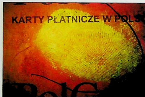
Ryc. 4. Ujawniony ninhydryną 5-dniowy ślad linii papilarnych na wydruku z bankomatu – warstwa chłonna – kompleksowany jonami Zn^{2+} , pobudzany światłem oświetlacza Multikolor 10Xe 505 nm; filtr oględzinowy OG 550
