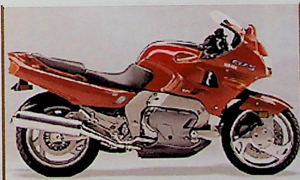
Ryc. 1. Pierwszy motocykl na świecie ze skrotną piastą koła przedniego – Yamaha GTS1000A (zdj. pochodzi z zasobów Internetu) Fig. 1. World first motorbike with torsional wheel hub – Yamaha GTS1000A
