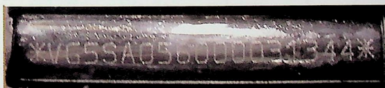
Ryc. 7. Pole numerowe ramy motocykla oraz znaki graficzne numeru VIN – skuter Yamaha BW's 50 Fig. 7. Yamaha BW's 50 scooter; number filed on frame including graphic signs
