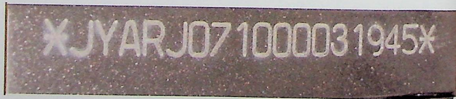
Ryc. 3. Pole numerowe ramy motocykla oraz znaki graficzne numeru VIN – model Yamaha FZ6 Fig. 3. Yamaha FZ6; number field on frame including graphic signs
