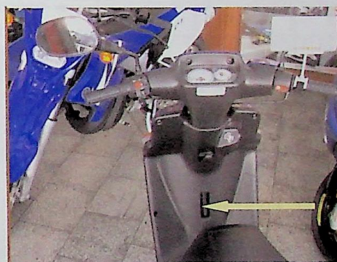
Ryc. 8. Umiejscowienie numeru VIN. Numer VIN – skuter Yamaha BW's 50 Fig. 8. Yamaha BW's 50 scooter; location of VIN
