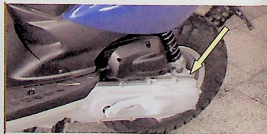
Ryc. 20. Umiejscowienie numeru silnika – skuter Yamaha BW's 50
