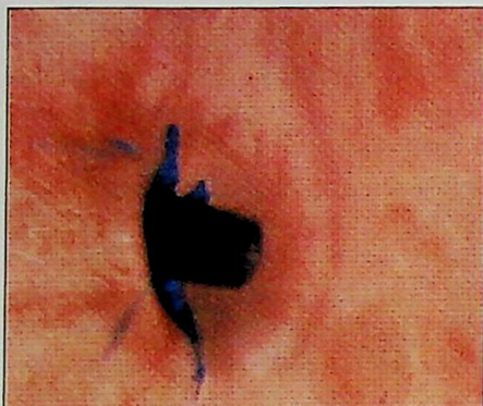
Ryc. 3. Zdjęcie z kamery wysokosprawnej (5000 obrazów/s) podczas strzału do świńskiej skóry
