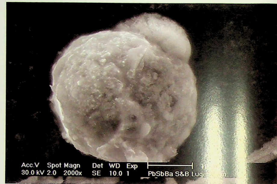
Ryc. 4. Typowa unikalna cząsteczka GSR – struktura obranej pomarańczy Fig. 4. Typical unigu GSR particle – „peeled orange” structure
