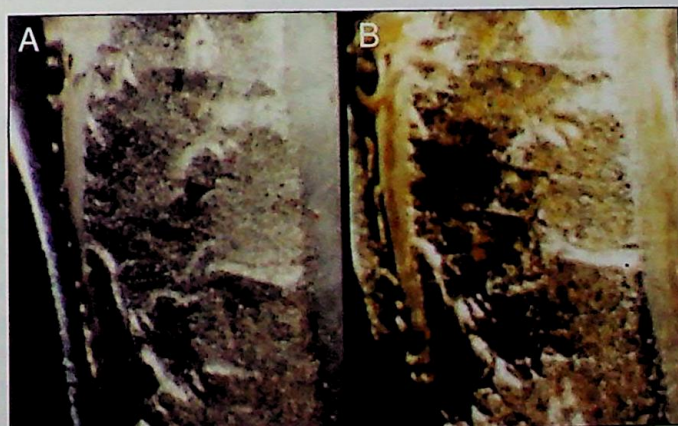
Ryc. 8. Cechy ujawnione na wewnętrznych powierzchniach pierścienia wzorca (A) i pierścienia gotowego wyrobu (B)
