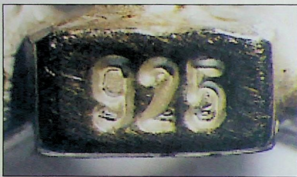
Ryc. 9. Cecha probiercza wybita na wzorcu-matce Fig. 9. Hallmark punched on parent template
