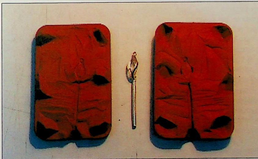
Ryc. 1. Forma jubilerska po wyjęciu wzorca-matki Fig. 1. Jeweller's mould after removing parent-template
