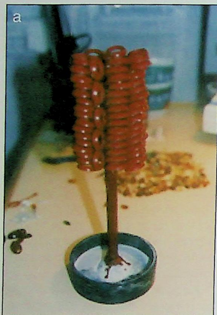
Ryc. 2. Choinki wykonane z masy modelowej (a) i srebra (b) Fig. 2. „Trees” made of mould material (a) and silver (b)
