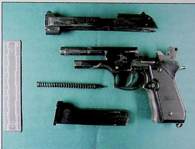
Ryc. 2. Przerobiony pistolet gazowy RECK MIAMI częściowo rozłożony
