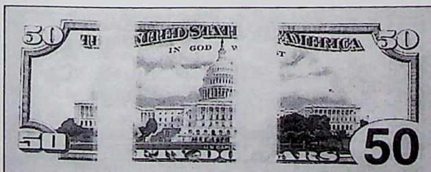
Ryc. 24, 25. Zabezpieczenie widoczne tylko w podczerwieni (IR). Technika fotografowania opisana w treści artykułu
