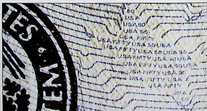
Ryc. 11, 12, 13, 14. Umieszczenie mikrodruku wykonane techniką stalorytu. Przy wykonaniu tych zdjęć źródło światła ustawione było pod bardzo ostrym kątem do fotografowanego fragmentu, zastosowano również miarę i obiektyw makro
