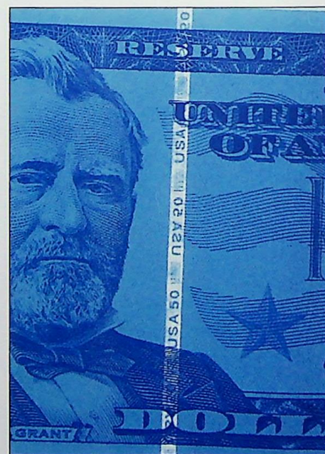
Ryc. 21. Fragment nitki zabezpieczającej na banknocie 20-dolarowym widziany w oświetleniu UV. Opis techniki wykonania zdjęcia w treści artykułu Fig. 21. Fragment of securing thread on a twenty dollar note seen in UV light. Photographing technique described in article.
