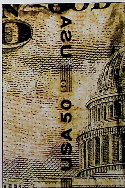
Ryc. 17, 18. Fragment nitki zabezpieczającej. Zdjęcie wykonane w prześwicie (światło przechodzące), wykorzystano również obiektyw makro
