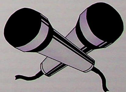
Ryc. 2. Rozmieszczenie mikrofonów w układzie X-Y Fig. 2. Arrangement of microphones in X-Y scheme
