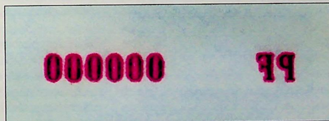
Ryc. 1, 1a. Numerator wykonany farbą penetrującą. Po obu stronach papieru widoczne są charakterystyczne „krwawienia” Fig. 1, 1a. Number stamp made by penetrating paint. Characteristic bleeding effect visible on both paper sides
