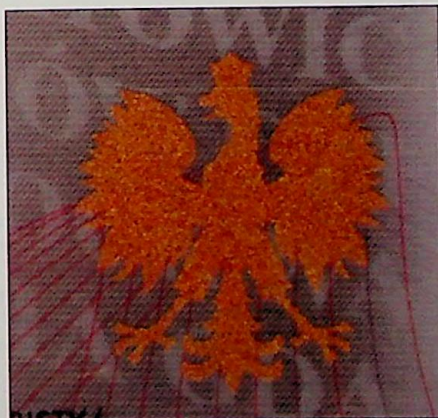
Ryc. 2, 2a. Element wykonany farbą zmienną optycznie (OVI). Kolory farby zmieniają się w zależności od kąta odbicia światła ze złotego na zielony Fig. 2, 2a. Element made in optically variable ink (OVI). Paint colours change from golden to green, depending on the light reflection angle
