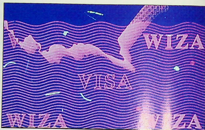
Ryc. 6, 6a. Zabezpieczenie farbą dwuzakresową wykazującą luminescencję w UV. W zakresach długości fal 365 nm oraz 254 nm farba emituje dwa różne kolory
