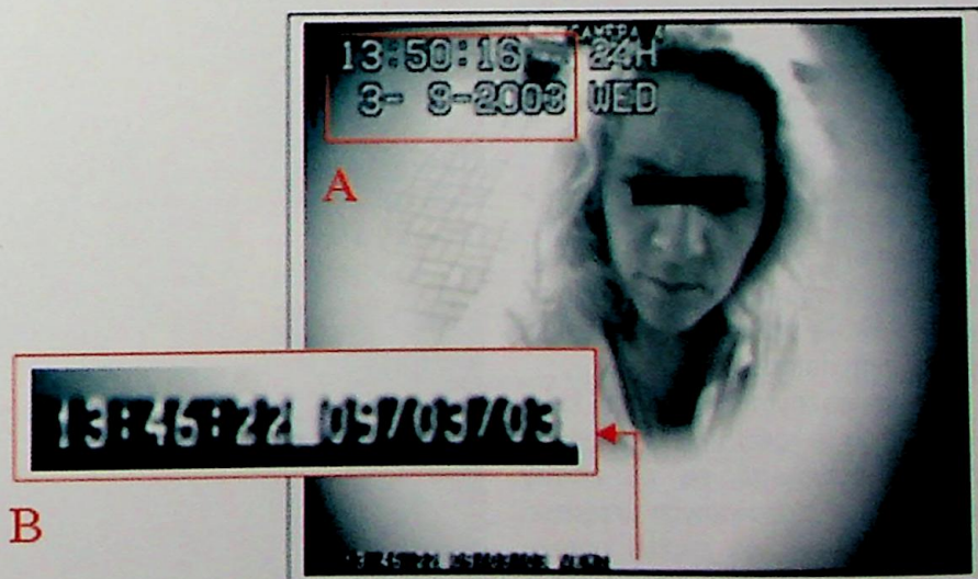
Ryc. 1a. Data i czas rejestracji obrazu podawana przez urządzenie zapisujące, b – data i czas rejestracji obrazu podawana przez multiplexer
