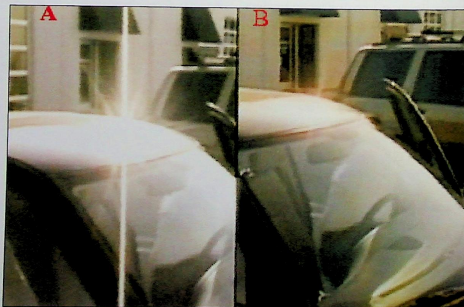
Ryc. 3a. Obraz z kamery z przetwornikiem CCD, b – obraz z kamery Hyper-D
