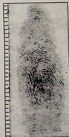
Ryc. 10. Ślad linii papilarnych ujawniony za pomocą RSM na taśmie dwustronnej Fig. 10. Latent fingerprint developed with use of RSM on two-sided tape
