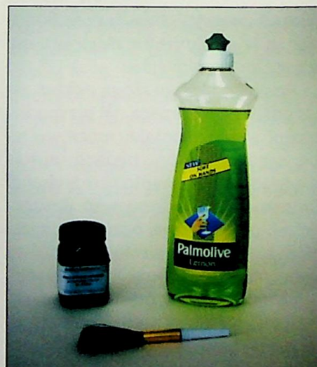
Ryc. 4. Proszek czarny Bristol Black z płynem do mycia naczyń Palmolive Lemon i pędzelkiem z sierści wielbłąda Fig. 4. Black powder Bristol Black with disk washing liquid Palmolive Lemon and with regular camel hair brush
