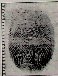
Ryc. 12. Ślad linii papilarnych ujawniony za pomocą kleju cyjanoakrylowego i RSM na taśmie przezroczystej – biurowej Fig. 12. Latent fingerprint developed with use of cyanoacrylate and RSM on transparent - office tape
