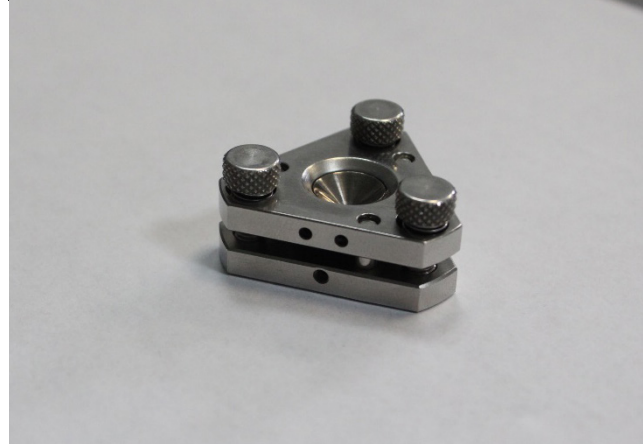
Ryc. 13, 14. Spektrometria w podczerwieni z transformacją Fouriera z celą diamentową
