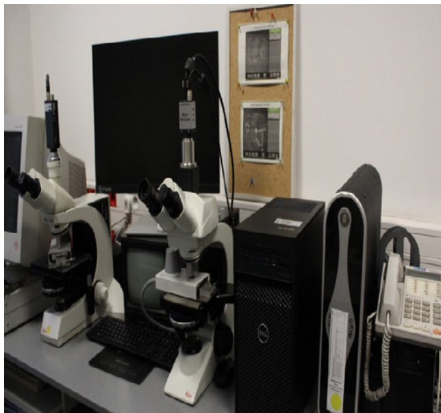
Ryc. 11. Zestaw do badania współczynnika załamania światła GRIM III
