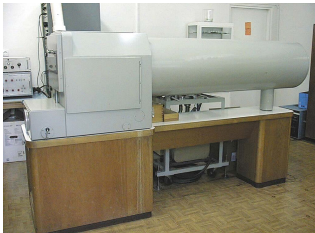
Ryc. 2. Spektrograf PGS-2 firmy Zeiss
