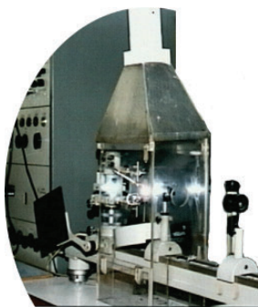
Ryc. 1. Statyw spektrografu, w którym mocowane są elektrody (w tle generator UBI-1)
