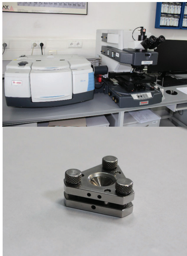
Ryc. 13, 14. Spektrometria w podczerwieni z transformacją Fouriera z celą diamentową
