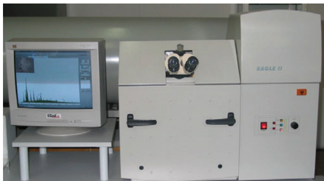
Ryc. 7. Spektrometr \mu -fluorescencji rentgenowskiej EAGLE II
