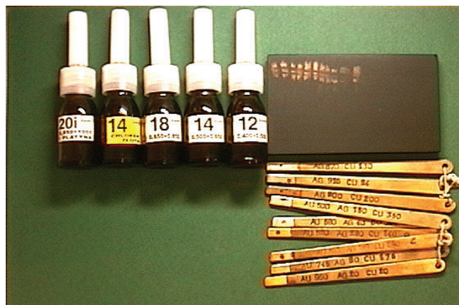
Ryc. 9. Zestaw do oznaczania prób wyrobów z metali szlachetnych
