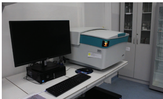
Ryc. 8. Spektrometr fluorescencji rentgenowskiej XEPOS
