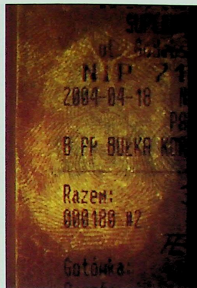
Ryc. 8. Ślad linii papilarnych ujawniony metodą DMAC na wydruku z kasy fiskalnej: światło wzbudzenia 505 nm, pomarańczowy filtr oględzinowy Fig. 8. Latent fingerprint developed with DMAC method on a printout (receipt): excitement light of 505 nm, orange viewing filter
