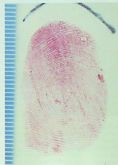
Ryc. 12. Ślad linii papilarnych ujawniony metodą ninhydrynową na papierze kserograficznym po zastosowaniu metody DMAC, DFO: światło białe Fig. 12. Latent fingerprint developed with ninhydrin method on photocopying paper following the use of DMAC, DFO: white light
