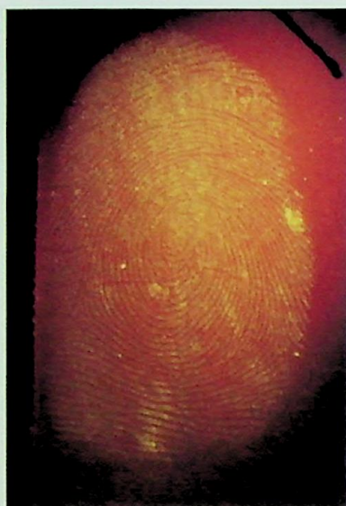
Ryc. 10. Ślad linii papilarnych ujawniony metodą DMAC na papierze kserograficznym: światło wzbudzenia 505 nm, pomarańczowy filtr oględzinowy Fig. 10. Latent fingerprint developed with DMAC method on photocopying paper: excitement light 505 nm, orange viewing filter
