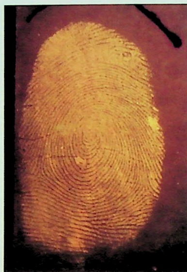
Ryc. 11. Ślad linii papilarnych ujawniony metodą DFO na papierze kserograficznym po zastosowaniu metody DMAC: światło wzbudzenia 505 nm, pomarańczowy filtr oględzinowy Fig. 11. Latent fingerprint developed with DFO method on photocopying paper after DMAC has been applied: excitement light 505 nm, orange viewing filter
