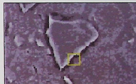
Ryc. 44. Szkiełko i olejek poniżej temperatury równowagi (linia biała po stronie wewnętrznej a czarna po zewnętrznej) Fig. 44. Slide and oil below match point temperature (white line on the inner, and black line on the outer side)
