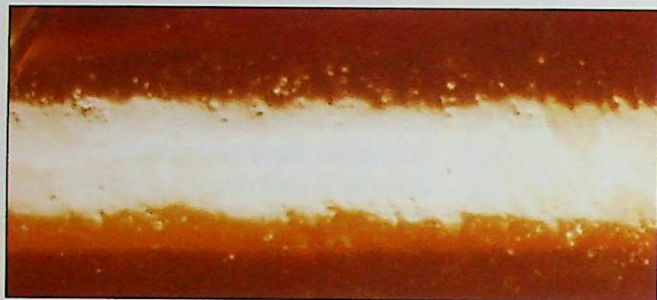
Ryc. 13. Powierzchnia zewnętrzna butelki (powierzchnia ta miała kontakt z powierzchnią metalowej formy w czasie formowania) Fig. 13. Bottle external surface (having been in contact with metal mould during moulding process)
