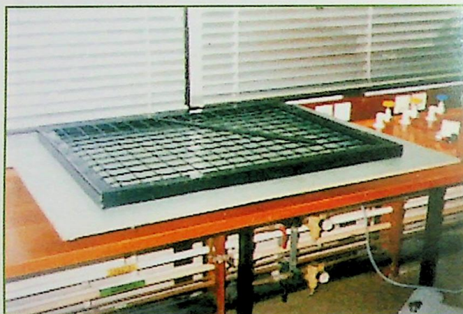
Ryc. 29. Stalowa krata wykorzystywana w NFI (Rijswijk) do zbierania wytrzepin z odzieży Fig. 29. Steel crate used in NFI (Rijswijk) for collection of shaken off clothes particles
