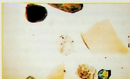
Ryc. 30. Obraz mikroskopowy piasku i szkła (nikole są równoległe). Drobiny szkła dobrze widoczne
