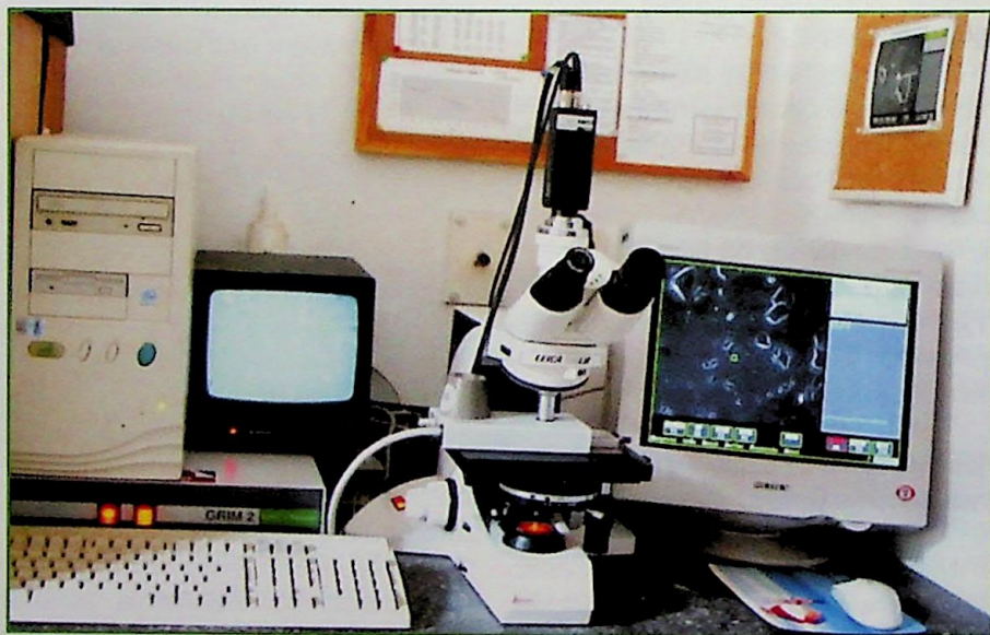
Ryc. 34. Zestaw GRIM 2 znajdujący się w wyposażeniu Wydziału Chemii CLK KGP Fig. 34. GRIM 2 equipment at CFLP Chemistry Department
