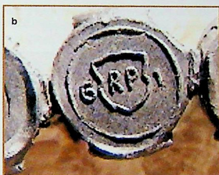
Ryc. 3. Rewersy oryginalnych plomb z cechą legalizacyjną wyciśniętą: głębiej (a) i płycej (b) Fig. 3. Reverses of original seals with deep (a) and shallow (b) stamps
