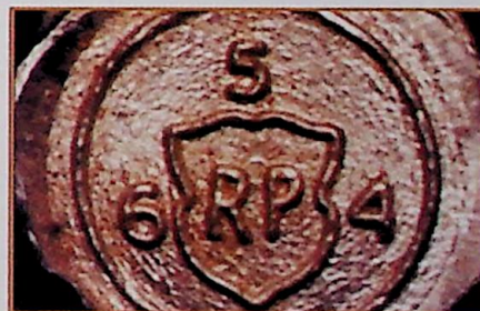
Ryc. 2. Awers, czyli cecha urzędu miar z nadanym numerem stempla Fig. 2. Averse; stamp of weights and measurements office with stamp number
