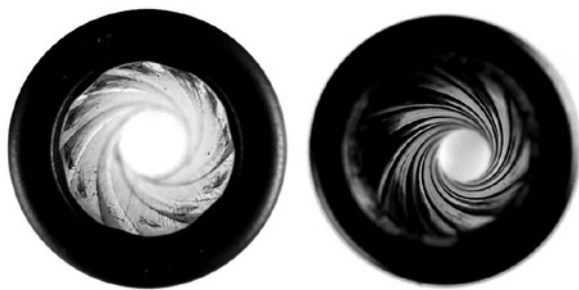
Ryc. 1. Gwint poligonalny gen. 3 (po lewej stronie) – Gwint Marksman Barrel gen. 5 (po prawej stronie) – opracowanie własne
