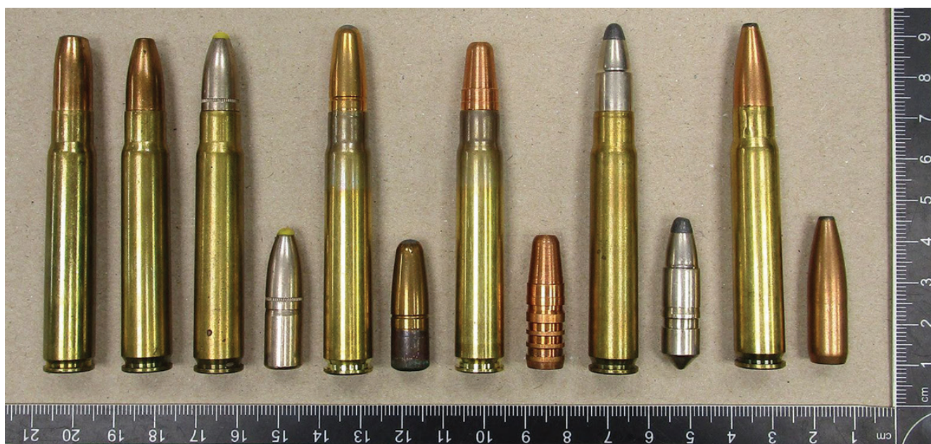
Ryc. 3. Naboje sztucerowe kal. 9,3 x 62 mm różnych producentów (od lewej): Sellier & Bellot, Norma, Norma z pociskiem „Plastic Point”, Lapua z pociskiem „Mega”, Lapua z pociskiem „GPA”, RWS z pociskiem „TUG”, T z pociskiem „SP”
