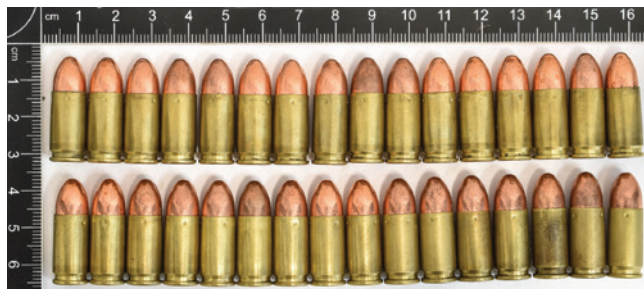
Ryc. 5. Amunicja do pistoletu – widok ogólny, z widocznymi punktami wzmacniającymi osadzenie pocisku w łusce
