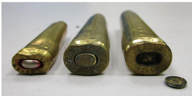
Ryc. 4. Widok den łusek naboju zgniecionych bocznie w szczękach imadeł. Dno miseczki spłonek łuski naboju sztucerowego kal. 9,3 x 62 mm produkcji fińskiej odpadło. Spłonki nie odpaliły
