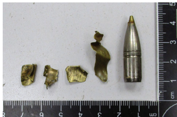
Ryc. 2. Dowodowy pocisk wydobyty z ciała pokrzywdzonego oraz fragmenty rozerwanej łuski ujawnione na miejscu zdarzenia
