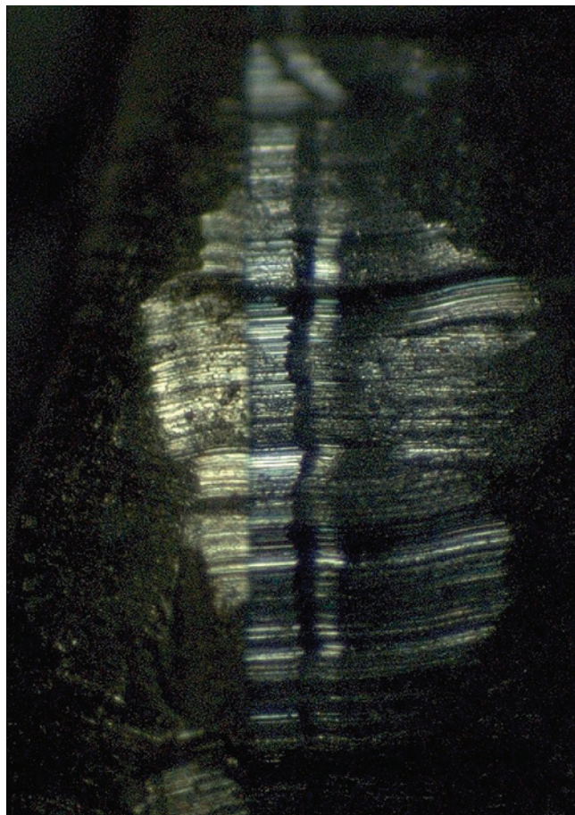
Ryc. 10. Zestawienie cech śladów przewodu lufy na dowodowej spłonce i pocisku porównawczym
