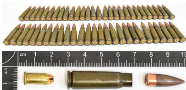
Ryc. 14, 15. Amunicja do pistoletu maszynowego – widok ogólny oraz części składowe
