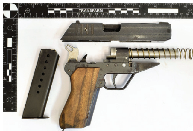
Ryc. 2. Pistolet – widok ogólny z prawej strony po rozłożeniu na podstawowe części
