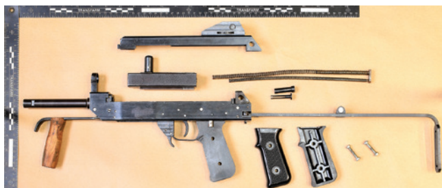
Ryc. 8. Pistolet maszynowy – widok ogólny z lewej strony po rozłożeniu na podstawowe części
