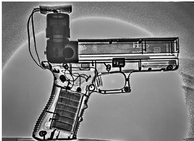
Ryc. 2. Pistolet kal. 15 mm wytworzony w sposób samodzielnego – zdjęcie RTG
