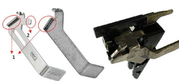
Ryc. 6. Od lewej strony: przerywacz GHOST źródło: https://besthunters.pl/ dostęp z dnia 26.08.2026 r., gdzie: 1 – powierzchnia, po której porusza się szyna spustowa; 2 – TCT Trigger Control Tab. Przerywacz fabryczny źródło: https://coltwroclaw.pl/ , dostęp z dnia: 26.08.2026 r., fragment mechanizmu spustowego z widoczną szyną spustową i powierzchnią przerywacza po której się porusza (mechanizm z zamontowanym fabrycznym konektorem)
