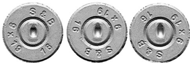
Ryc. 1. Łuski odstrzelone z trzech różnych egzemplarzy pistoletu Glock 17. Od lewej: pistolet nr 1, nr 2 oraz nr 3
